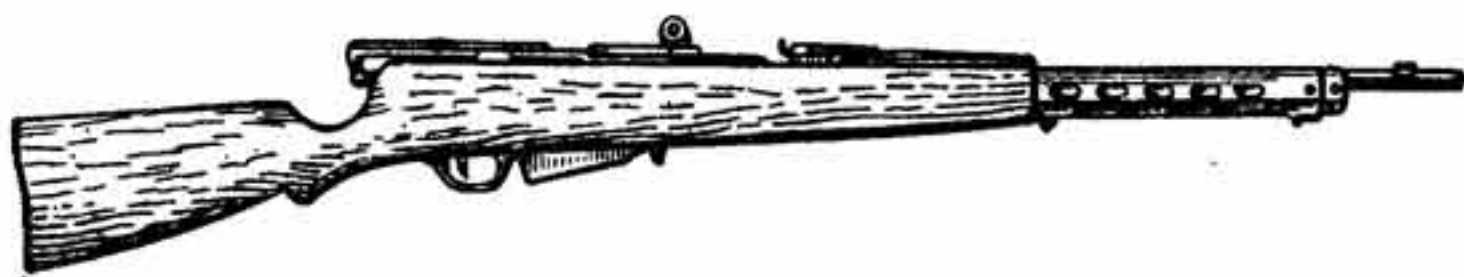
Р и с. 15 Автоматическая винтовка В. Г. Федорова
