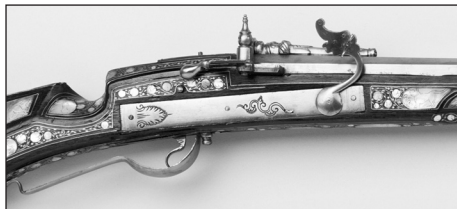
Рис. 1. Фитильный замок на голландском мушкете 1610-х гг. Музеи Московского Кремля. Инв. № Ор-254
