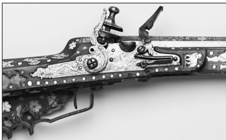
Рис. 12. Замок французского типа на пищали работы мастера Филиппа Тимофеева Болдырева (Оружейная палата, конец 1670 – начало 1680-х гг.). В Переписной книге этот замок ошибочно назван «шкоцким». Музеи Московского Кремля. Инв. № Ор-1939
